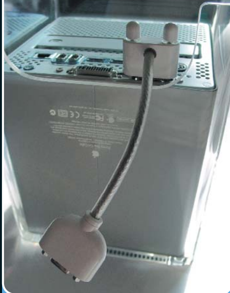
Esse “cotovelo” serve para ligar os conectores grandes de monitores SVGA ao Cubo. Não se engane: ele não deixa de ser uma gambiarra
