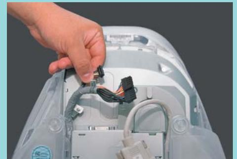
**Pegadinha:** se o seu iMac é da série original (Bondi Blue), existe ainda o cabo do sensor infravermelho. Solte-o antes dos outros cabos.
