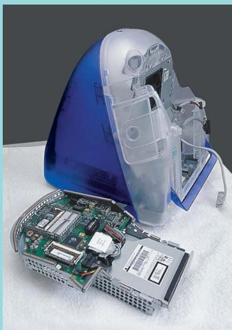
De cara, você pode notar que o HD pode ser facilmente trocado; para ter acesso a ele, basta tirar o CD-ROM de cima (conhecimento útil para o futuro). O CD-ROM não é aparafusado, e sim precariamente encaixado em um esquema de arames sob tensão. Além de poder dar um belo susto ao soltar-se repentinamente do conjunto, o sistema de encaixe do CD-ROM é o motivo de ele (provavelmente) não ficar bem centralizado no painel do seu iMac.
