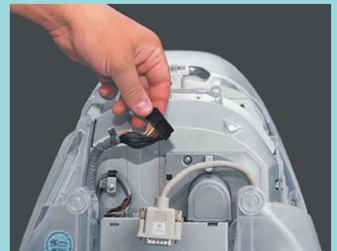
O conector menor vai simplesmente encaixado, mas em alguns iMacs o cabo tem um pequeno parafuso de suporte.
