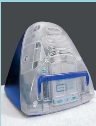
**3** Solte o parafuso que fica por trás da alça plástica arredondada, na parte traseira. Coloque-o no recipiente, que evitará que ele e os demais parafusos se percam ou (aargh!) entrem para baixo da tela e risquem tudo.
