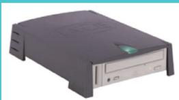
2x2x6, ou seja, grava e regrava em 2x e lê em 6x. A empresa resolveu limitar a performance de gravação a 2x porque, a 4x, não haveria margem suficiente para outros dispositivos USB conectados ao mesmo bus trabalharem. Junto com o drive vêm alguns programas de gravação modificados, incluindo o Toast, da Adaptec. O produto é feito de plástico azul e traz um ponto em verde translúcido que acende quando o drive é ligado. O preço ainda não tinha sido divulgado até o fechamento desta edição.
