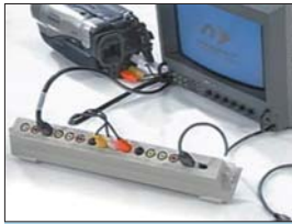
FireStorm AV, da Newer : linha direta entre o equipamento de vídeo e o FireWire
