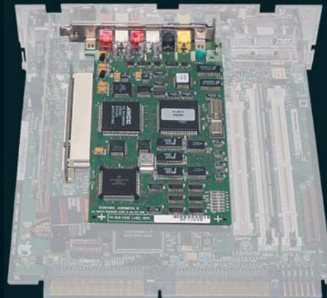
Placa de som Audiomedia III , instalada no slot PCI único de um Performa 6360
