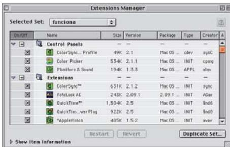
Um set para Photoshop precisa do driver do scanner (que costuma ficar junto com as extensões), ColorSync (só se for usado) e QuickTime (responsável pelo JPEG)
